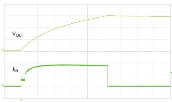
$\rm V_{BAT}$  = 11 V. C1,  $\rm V_{OUT}$  100 V/div; C4,  $\rm I_{IN}(av)$  200 mA/div; Time 500 ms/div.
