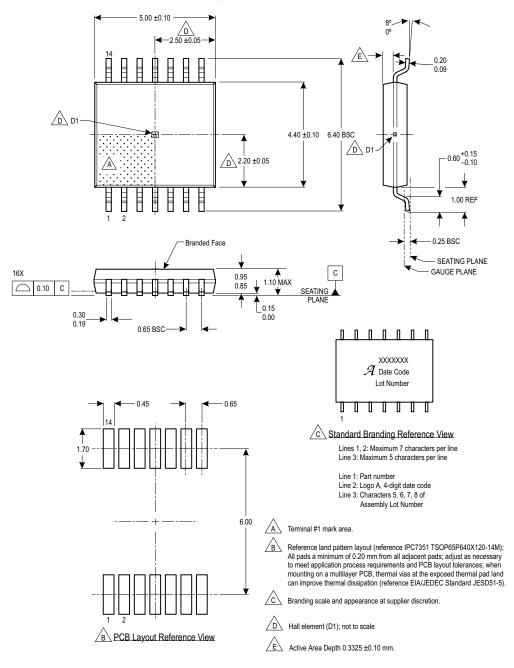
Figure 33: Package LE, 14-Pin TSSOP, single die
