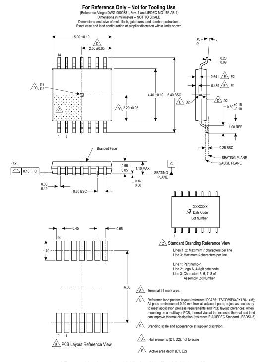
Figure 34: Package LE, 14-Pin TSSOP, dual die
