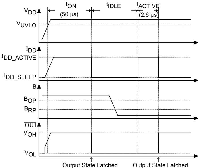
Figure 45: CT813x Power-On Timing Diagram
