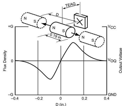
**Fig. 15. Slide-by, lateral orientation**
