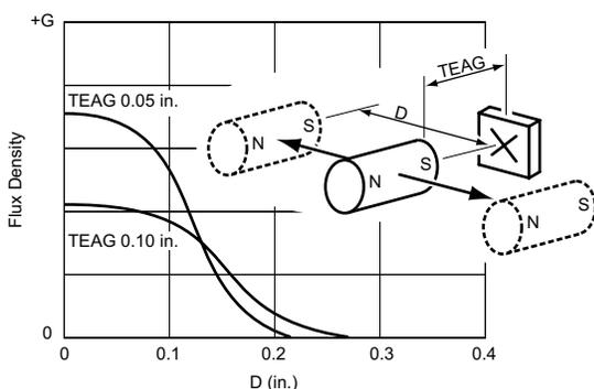
**Fig. 14. Slide-by, head-on orientation**
