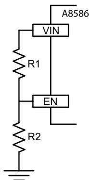
$$V_{IN(START)} = \frac{R1 + R2}{R2} V_{EN(H)} \quad (1)$$
